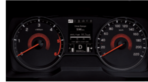
Zestaw wskaźników z 3,5" monochromatycznym wyświetlaczem LCD
